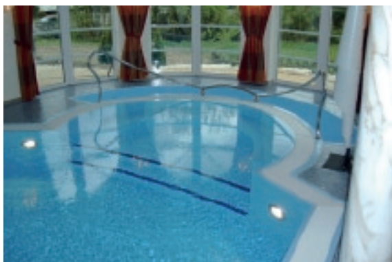
Freiform-Solebecken mit Überlaufrinne, Luftsprudelbank und angebundenem Kneippbecken. Komplett freitragend.
